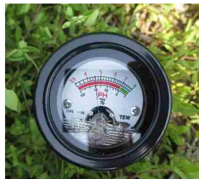
土壤挿入型酸度計(pH計)はpH4.5を示している -10-
