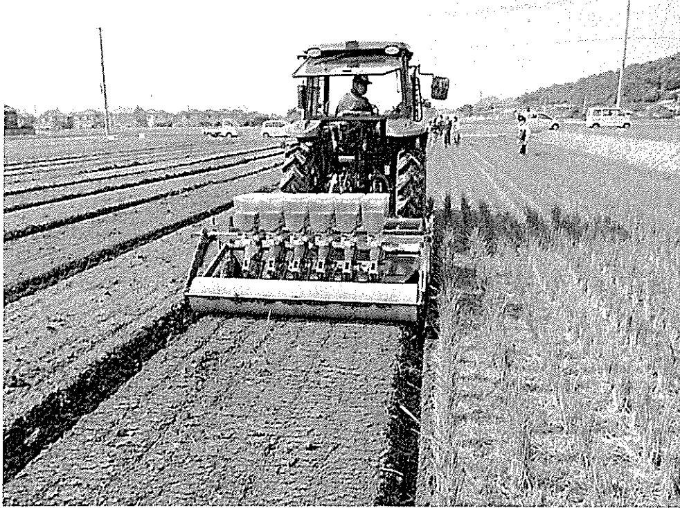
1回耕でも碎土や稲株の鋤込み精度が良いので、すぐ播種できる
