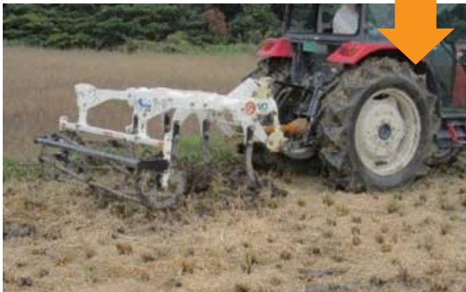
スタブルカルチの施工
