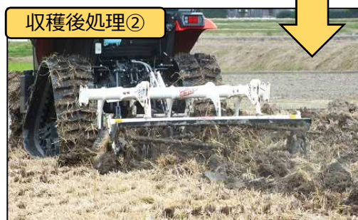
スタブルカルチの施工
